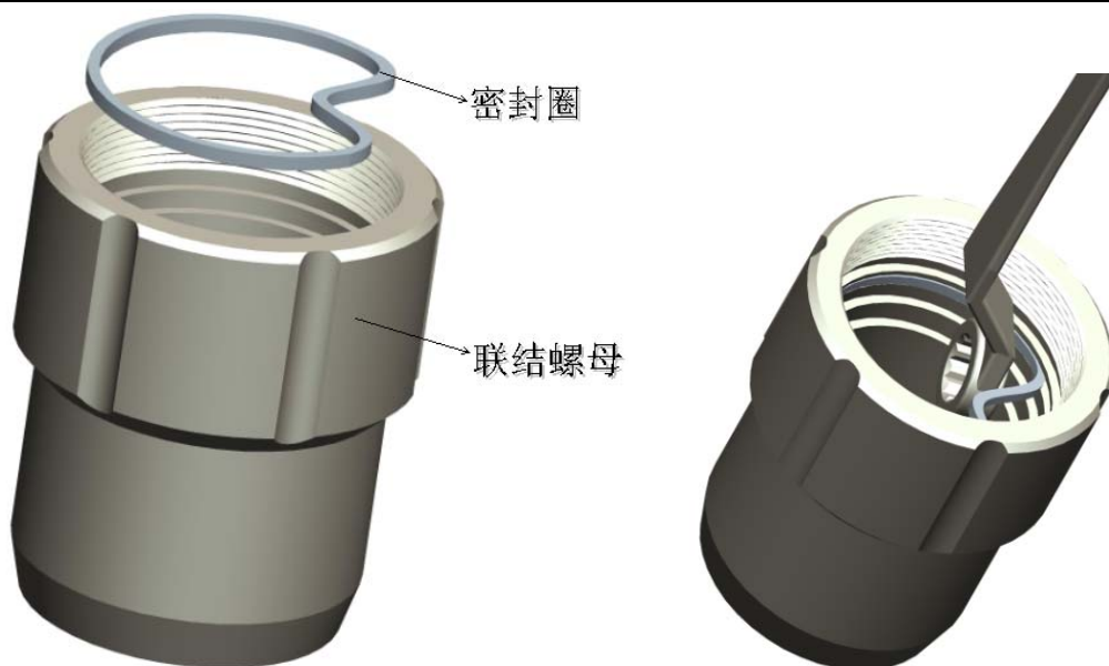
图六 矩形密封圈的装配示意图
