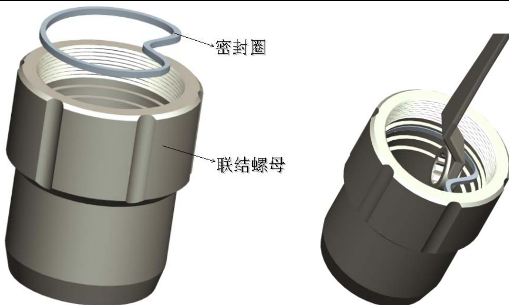
图六 矩形密封圈的装配示意图
